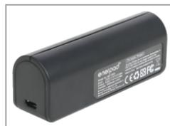
**Nota:** per ricaricare il External Battery Pack, scollegarlo dall'Hub e quindi collegarlo al TI Wall Charger utilizzando il USB Standard A to Micro . Non utilizzare il External Battery Pack come fonte di alimentazione ausiliaria mentre è sotto carica.
