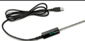
Este sensor analógico é conectado a uma porta USB do computador para recolher intervalos de temperatura.
